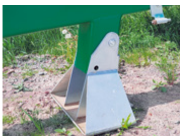
Galvaniserad, kraftig stödfot med mycket stor markplatta.
