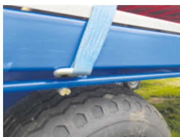
Surrningsrör under kantlinan längs hela flaket.
